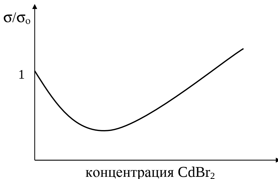
Рис.2. Зависимость относительной ионной проводимости в кристаллах \text{AgBr} от концентрации введенной примеси \text{CdBr}_2 при постоянной температуре.
